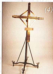
(3) Cuadrante acimutal y de altura (S. XVIII) utilizado por Jorge Juan y Ulloa en las mediciones de el Perú en 1736.
